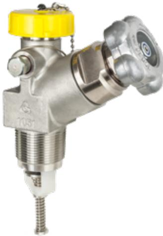
Предназначено для использования в качестве ручного или уравнительного клапана в резервуарах машин для распыления безводного амиака и СУГ резервуарах для его хранения. Этот клапан включает в себя встроенный скоростной клапан.
