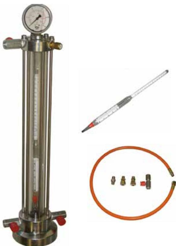
Предназначен для определения качества сжиженного углеводородного газа, а именно для определения соотношения его основных составляющих пропана и бутана.
